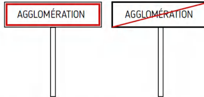
Panneaux de signalisation d'entrée et de sortie d'agglomération
